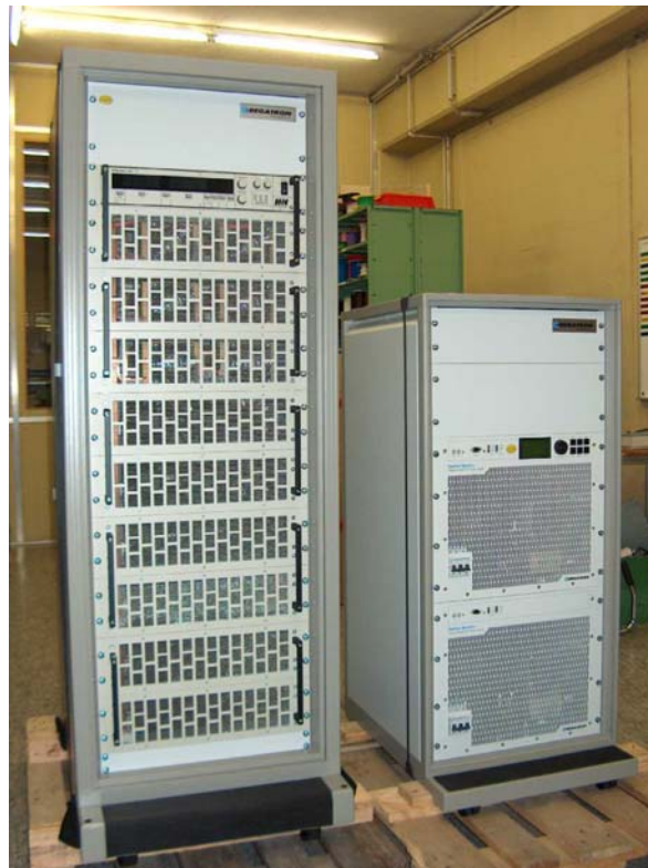
Figur 2: RESACT - Anlage mit 64 kW speisend, 22.5 kW rückspeisend vor der Auslieferung
